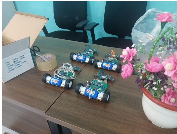
Gambar 1. Unit Robot Line Follower yang digunakan saat pelatihan
